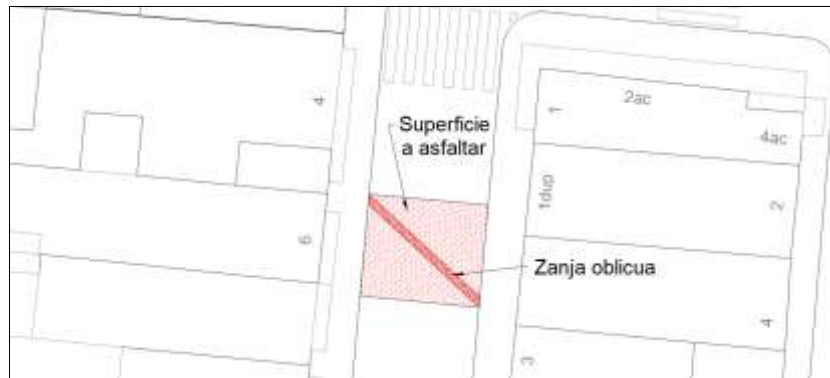
Figura 1. Afección 1 carril. Superficie mínima a asfaltar.
