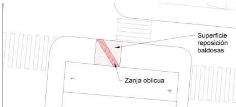
Figura 6. Superficie reposición baldosas en zanja oblicua.
