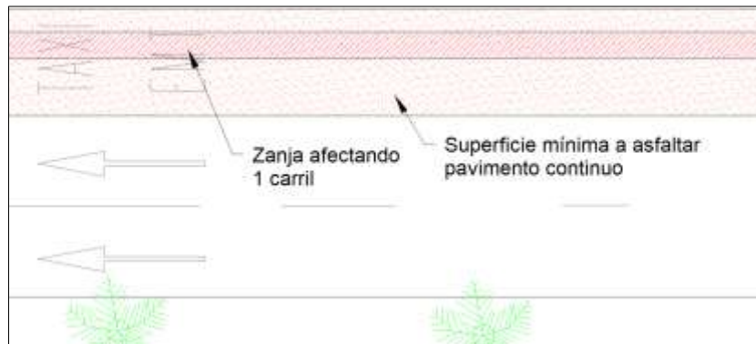
Figura 4. Afección 1 carril. Superficie a reasfaltar.
